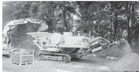
図46 自走式破砕機KOMATSU「ガラバゴス」
