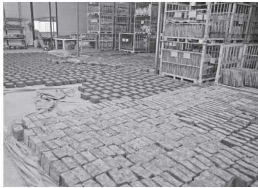
図266 日干し煉瓦乾燥の様子
