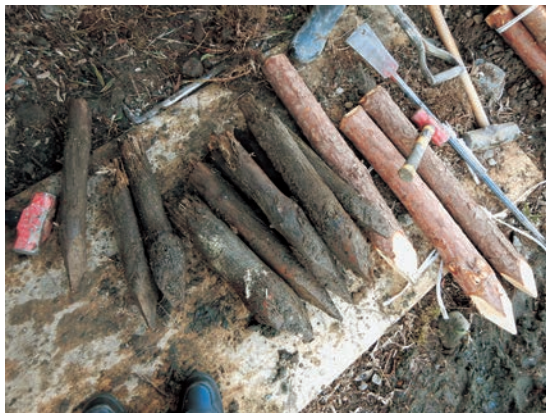
図4 (左) 撤去後乱杭 (右) 新規乱杭
