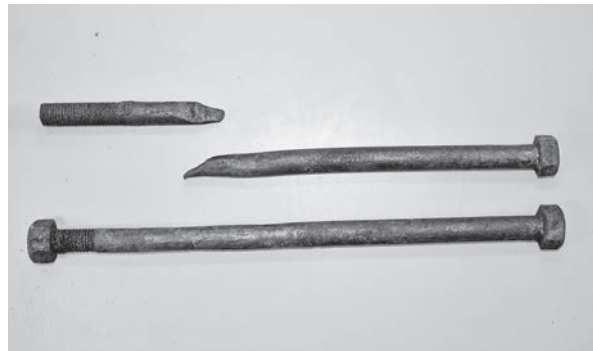
図146 トラス金物のボルト 隅行のボルトは長く、途中で鍛接されていた。
