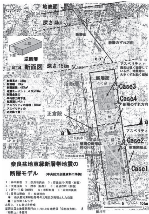
図115 想定奈良盆地東縁地震の断層モデル
